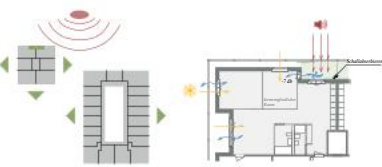
Wohnungsorientierung an lüftungswandlicher Seite und Loggia für Schallschutzfunktion
