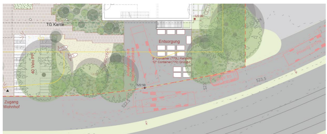
Abbildung 16 Schleppkurve Wendemanöver Müllfahrzeug (Plan: Chaves Biedermann Landschaftsarchitekten GmbH)
