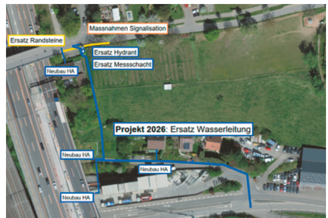
Erweitertes Projekt 2026 (HA = Hausanschlüsse)
