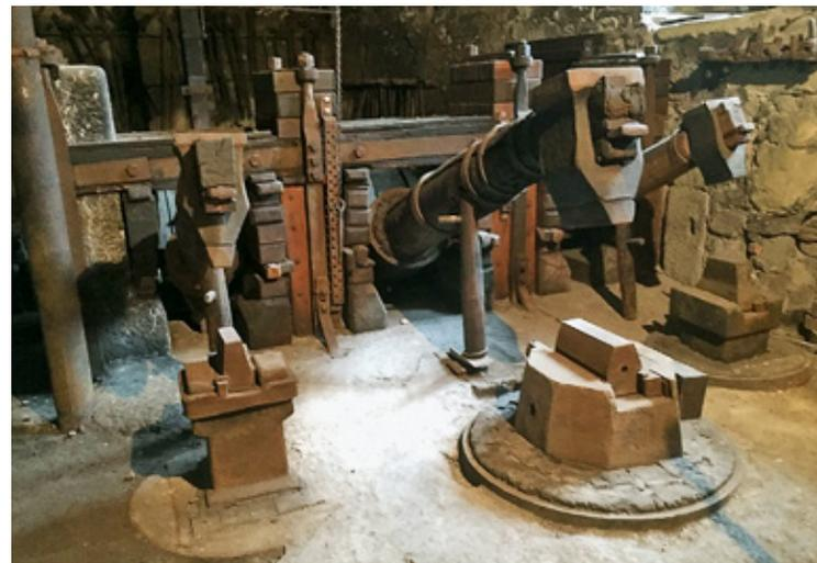
Die Hammeranlage mit dem hölzernen Wellbaum und den wassergetriebenen Schwanzhämmern aus dem 17. Jahrhundert zeugt von der industriegeschichtlichen Entwicklung. Die Anlage wurde zwischen 1677 und 2014 für die Metallverarbeitung genutzt. Sowohl der Wellbaum und die Hämmer, wie auch die grosse Esse und das 1996 rekonstruierte Wasserrad, funktionieren noch.
